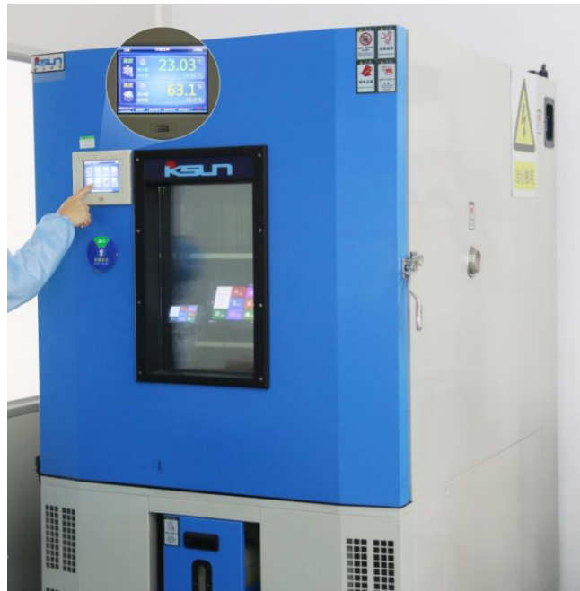
图 4-4 高低温老化测试图
